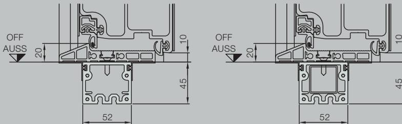
Bei Pfostenkonstruktionen mit eingeschobener durchgehender Rohrverstärkung (rechte Abb.).
