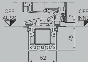
Bei Pfostenkonstruktionen mit eingeschobener durchgehender Rohrverstärkung (rechte Abb.).
