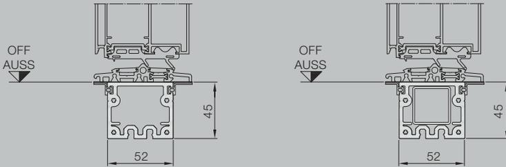
Bei Pfostenkonstruktionen mit eingeschobener durchgehender Rohrverstärkung (rechte Abb.).
