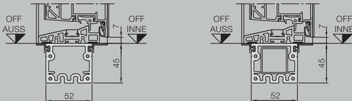
Bei Pfostenkonstruktionen mit eingeschobener durchgehender Rohrverstärkung (rechte Abb.).
